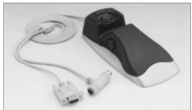
写真2 3Dコントローラ (エルゴポイント3D)
