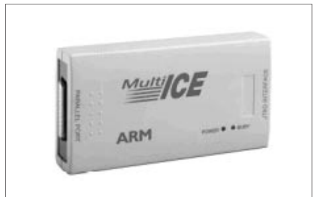
写真1 プロトコルコンバータ(Multi-ICEユニット)外観
