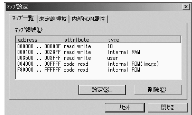
図3 シミュレータ/エミュレータデバッガの自動マップ設定
